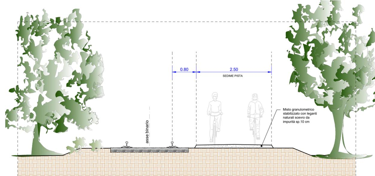
**2b** SEZIONE TIPO STATO DI PROGETTO (con binario)
