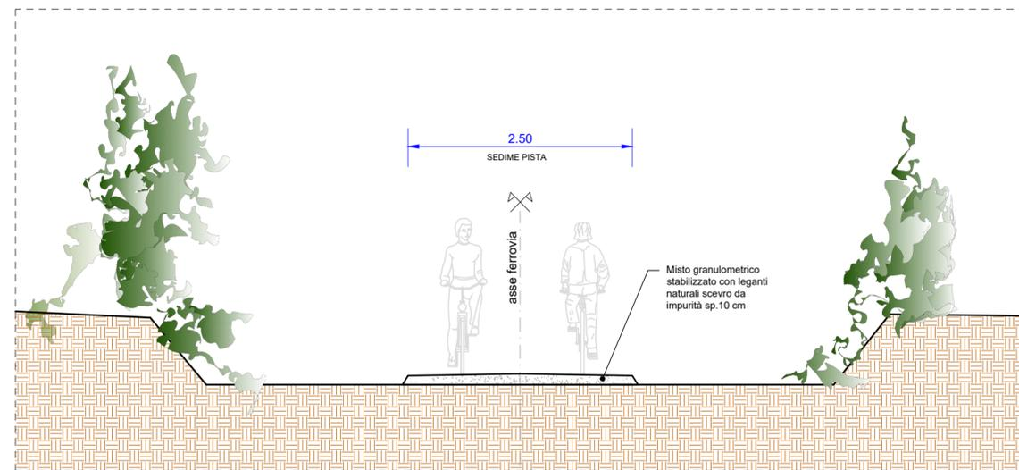
**1b** SEZIONE TIPO STATO DI PROGETTO (senza binario)
