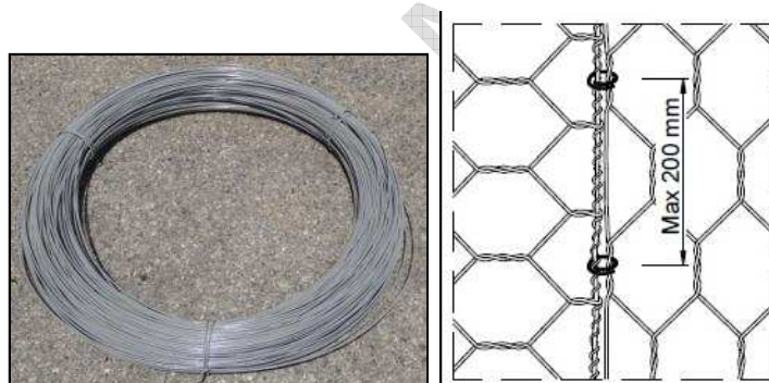
Fig. 4 – Filo di legatura: bobina e legatura
